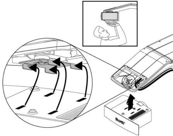
2. Надежно зафиксируйте проектор на планке при помощи винта, отвинченного при снятии проектора с кронштейна.
