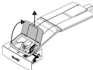
5. Если используете навесной замок для проектора, снимите его. При необходимости получения доступа к блокирующему винту проектора, открутите крыльчатую гайку и отсоедините проектор от экрана интерактивная доска, а затем затяните крыльчатую гайку.
