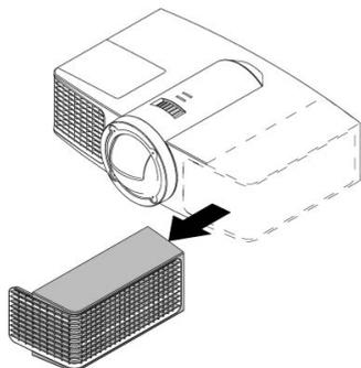
4. Надежно удерживая проектор и не прикладывая чрезмерных усилий к нему и к кронштейну, с помощью отвертки открутите и извлеките винт, удерживающий крышку проектора, а затем снимите крышку. Положите крышку и винты в надежное место.
