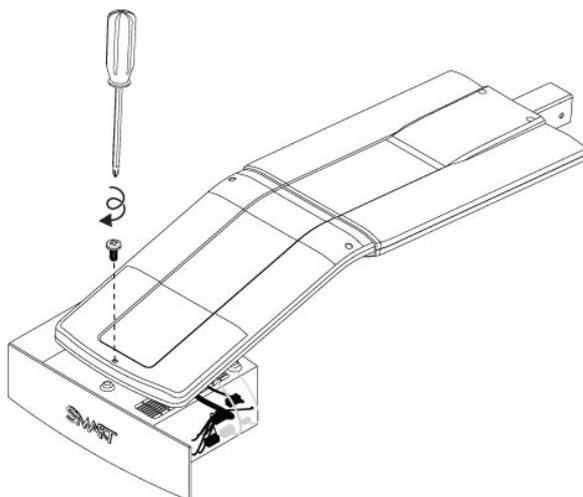
6. Подключите к проектору все кабели, а затем верните на место крышку отсека кабелей.
