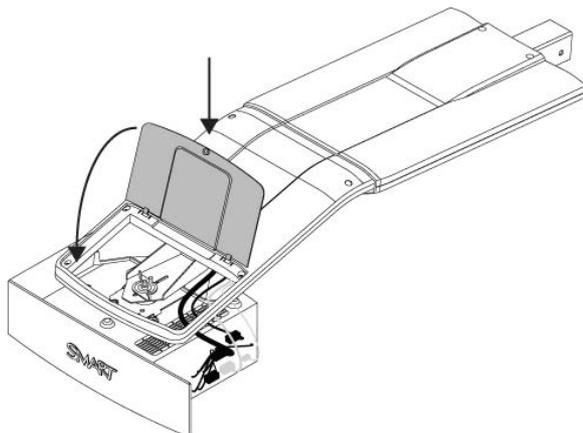
5. Не прилагая чрезмерных усилий, установите на место и надежно затяните винт крышки.
