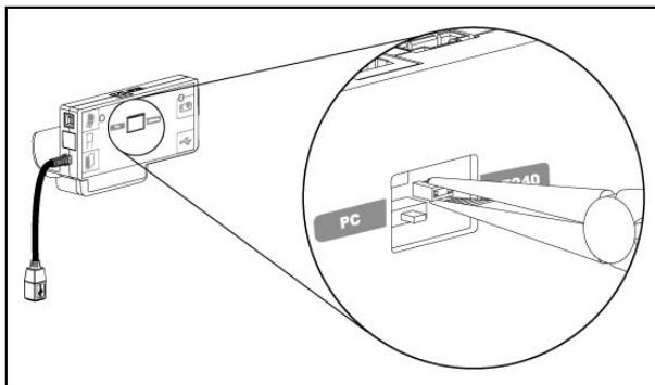
3. Вставьте крышку отсека перемычек в USB-порт А на передней панели РПУ.
