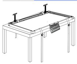
4. Если плоскопанельный экран установлен на стену, снимите его со стены и положите на интерактивную накладку лицевой стороной вниз.
