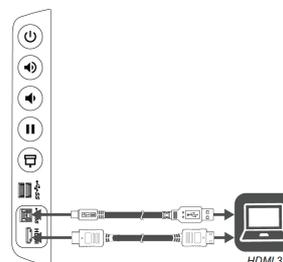
Après avoir branché à l'écran des ordinateurs et d'autres sources d'entrée, basculez entre ces sources d'entrée en affichant l'écran d'accueil, en tapant sur **Entrée** 🖥️, puis en sélectionnant une source d'entrée.
