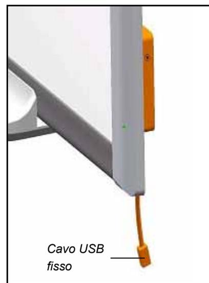
**Per eseguire la connessione con un cavo USB**
